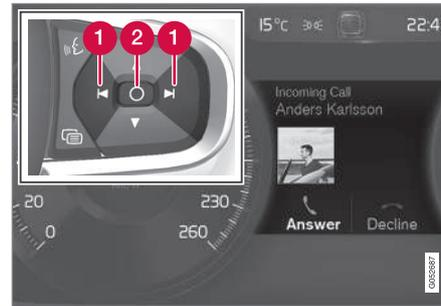
Mensaje en la pantalla del conductor y teclado derecho del volante.
