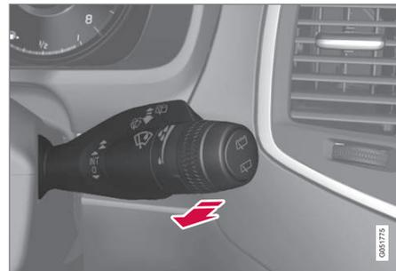
Función de lavado, palanca derecha del volante.
