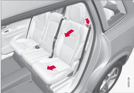
1. Tire hacia arriba y hacia adelante de la palanca que hay en la parte superior de los asientos laterales de la segunda fila de asientos.
