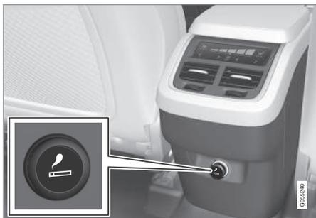
Encendedor en la consola del túnel, segunda fila de asientos.
