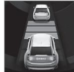
El conductor puede seleccionar diferentes intervalos de tiempo que se indican en la pantalla del conductor en forma de 1 a 5 rayas horizontales.
