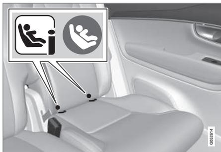
La ubicación de los puntos de fijación se indica con símbolos<sup>4</sup> en el tapizado del respaldo.
