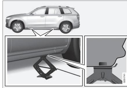
Eleve el gato hasta que entre en contacto con el punto de apoyo del gato en el vehículo. Compruebe que el gato esté debidamente colocado en la fijación, de forma que la espiga del gato se adapte al orificio de la fijación y el pie quede en sentido horizontal debajo de la fijación. Asegúrese también de girar el gato de forma que la manivela quede tan lejos de lado del vehículo como sea posible. Los brazos de la manivela quedan entonces en ángulo recto con respecto al vehículo.
