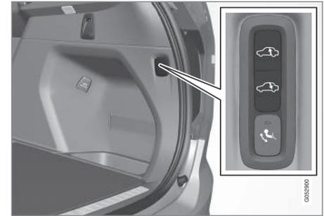
Control de elevación y descenso de la sección trasera del vehículo.
