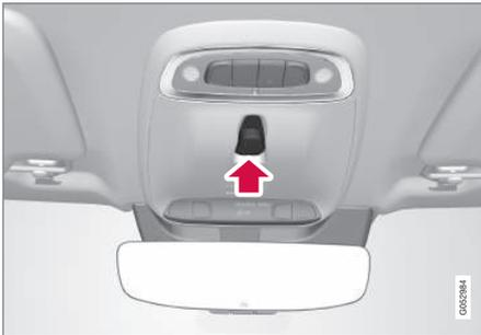
El techo panorámico y la cortinilla se accionan con un mando que está situado en el techo. El mando se activa cuando el sistema eléctrico del vehículo está en la posición de encendido **I** o **II**.
