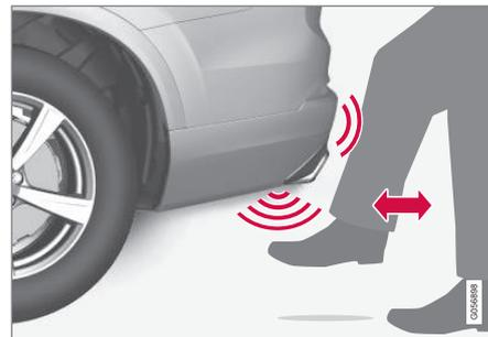
Movimiento con el pie en la zona de activación prevista del sensor.
