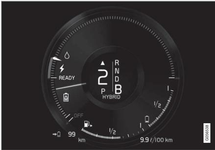
El vehículo genera corriente para la batería y la batería se carga, por ejemplo, cuando se pisa ligeramente el pedal de freno o cuando se activa el freno motor al bajar por una cuesta.
