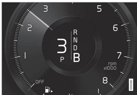
Posición B en la pantalla del conductor.
