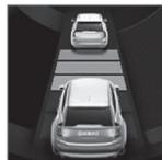
El conductor puede seleccionar diferentes intervalos de tiempo que se indican en la pantalla del conductor en forma de 1 a 5 rayas horizontales. Cuanto más rayas, mayor es el intervalo de tiempo. Una raya equivale a una distancia de seguridad de aproximadamente 1 segundo, 5 rayas equivalen a 3 segundos.
