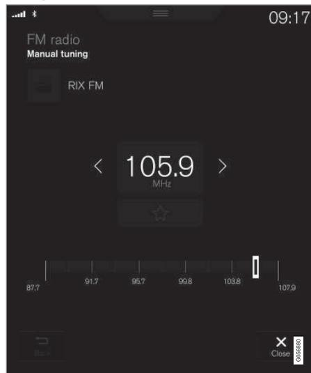
Cuando se pasa a búsqueda manual de emisoras, la radio deja de cambiar automáticamente de frecuencia si la recepción es deficiente.
