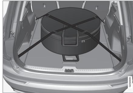
La rueda de repuesto se guarda en una bolsa que debe estar fijada con dos correas en el suelo del compartimento de carga durante la marcha. El respaldo de la tercera fila de asientos debe estar abatida.
