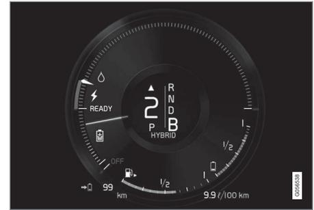
La pantalla del conductor indica carga al activarse el freno motor.
