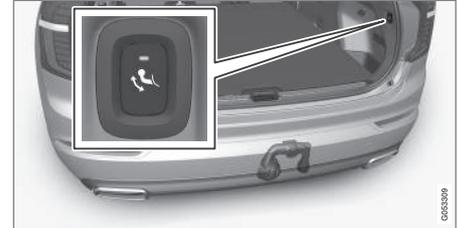
1. Abra el portón trasero. El botón para plegar y desplegar el enganche para remolque está situado en el lado derecho de la parte trasera del maletero. La luz de indicación se enciende con luz fija cuando está activa la función de despliegue.
