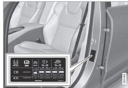
La placa de presión de neumáticos situada en el montante de la puerta del lado del conductor (entre la puerta delantera y la trasera) especifica la presión que deben tener los neumáticos en diferentes condiciones de carga y velocidad.
