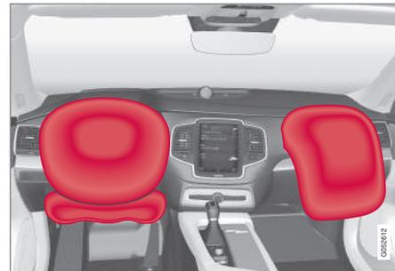
Airbags del conductor y del acompañante.
