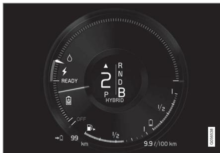
El vehículo genera corriente para la batería, la batería se carga, por ejemplo, al pisar suavemente el pedal de freno o al frenar con el motor cuesta abajo.
