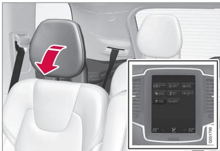
Los reposacabezas laterales pueden abatirse de dos maneras mediante la pantalla central:
