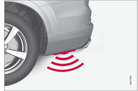
Si el vehículo está equipado con el accesorio Skid plate/Diffuser\*, el sensor está situado hacia la esquina izquierda del parachoques.
