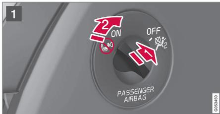
1 Tire del interruptor hacia fuera y gírelo de la posición **ON** (A) a **OFF** (B).
