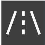
El sistema de permanencia en el carril se visualiza con un símbolo en la pantalla del conductor para diferentes situaciones.
