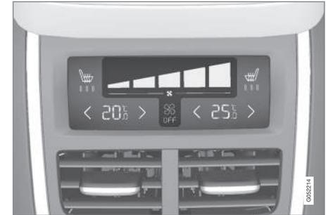
Control de ventilación en el panel de climatización de la consola del túnel.
