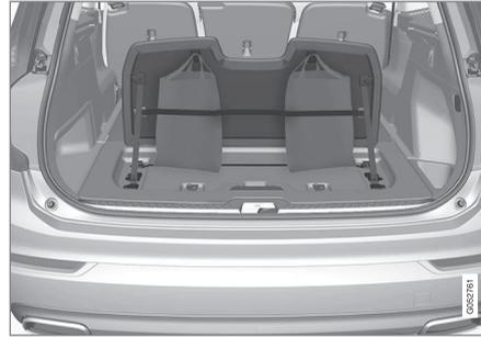
En la tapa que forma parte del suelo del maletero hay dos ganchos para bolsas de la compra y una cinta elástica<sup>2</sup>. La cinta puede colocarse en cuatro posiciones diferentes.
