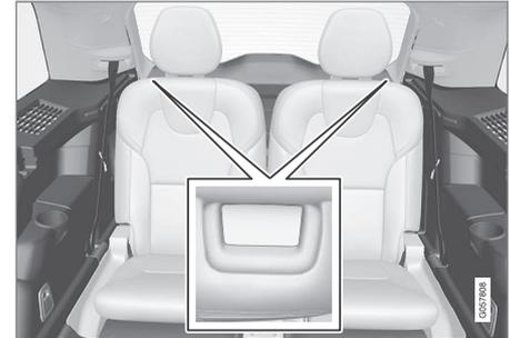
1. Tire hacia arriba y hacia adelante de la palanca situada en la parte superior del respaldo.
