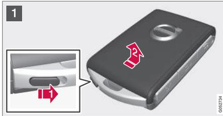
1 **1**▶ Mantenga la llave con la parte delantera visible y el logotipo de Volvo vuelto del lado correcto. Desplace hacia la derecha el botón en el borde del llavero. Deslice la carcasa de la parte delantera unos milímetros hacia arriba.
