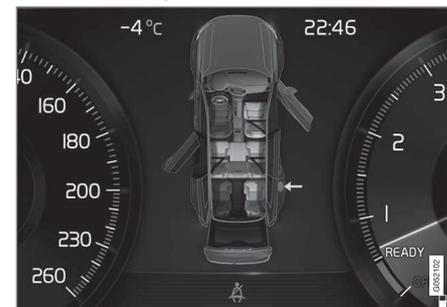
Gráfico en la pantalla del conductor con diferentes tipos de advertencias. El color de la advertencia de puertas y portón trasero dependen de la velocidad del vehículo.
