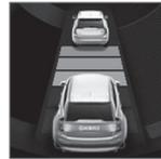
El conductor puede seleccionar diferentes intervalos de tiempo que se indican en la pantalla del conductor en forma de 1 a 5 rayas horizontales. Cuanto más rayas, mayor es el intervalo de tiempo. Una raya
