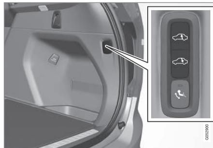
Utilice los botones en el maletero para regular la altura de la sección trasera y facilitar la carga y la descarga o el enganche y desenganche de un remolque. Véase el apartado "Colocación de carga".
