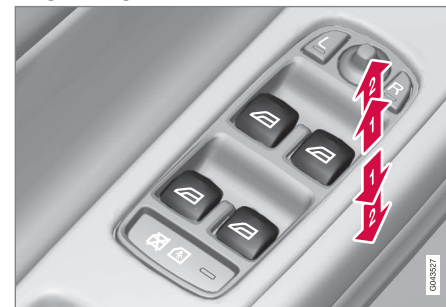
Regulering av vindusheiser.
