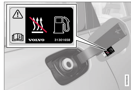
Πινακίδα στο εσωτερικό της θυρίδας ρεζερβουάρ καυσίμων.
