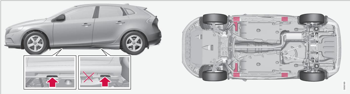
Las fijaciones del dispositivo elevador de taller (flechas) correspondientes al vehículo y los puntos de elevación (marcados en rojo).
