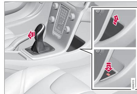
Si el automóvil no está en condiciones para conducirse, por ejemplo, si la batería de arranque está descargada, el selector de marcha debe sacarse de la posición **P** para poder mover el automóvil.
