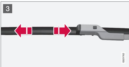
**1** Despliegue el brazo del limpiaparabrisas cuando se halle en posición de servicio. Pulse el botón situado en la fijación de la escobilla y tire en sentido recto hacia fuera paralelo al brazo.
