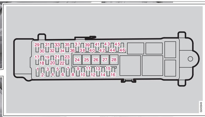
Detrás de la tapa de la **central eléctrica del compartimento motor** hay unas pinzas que facilitan la extracción e instalación de los fusibles.
