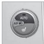
Gire la perilla para aumentar o reducir la velocidad del ventilador, **AUTO** se desconectará. Si se selecciona **AUTO**, la velocidad del ventilador se regulará de forma automática (p. 136). Se des-
