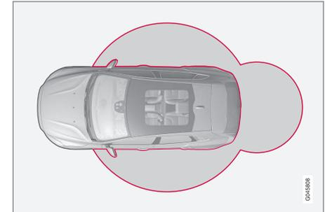
Los círculos rojos de la figura representan el radio de cobertura de las antenas del sistema.
