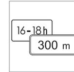
Algunas indicaciones de velocidad sólo son válidas, por ejemplo, durante un tramo determinado o un período específico del día. El sistema avisa al conductor sobre esta circunstancia con
