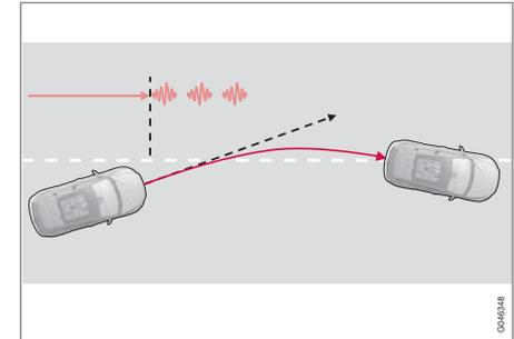
*El sistema de permanencia en el carril avisa con vibraciones en el volante<sup>27</sup>.*
