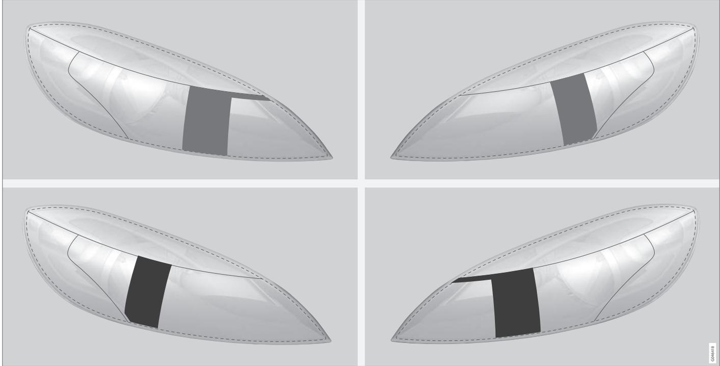
Línea superior: automóvil con volante a la izquierda, plantillas A y B. Línea inferior: automóvil con volante a la derecha, plantillas C y D.
