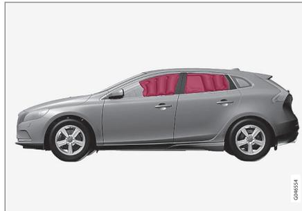
La cortina inflable (Inflatable Curtain) es una parte del sistema del sistema de airbags (p. 36). Está montado a lo largo de ambos lados del techo interior y protege a los ocupantes de las plazas exteriores. En caso de una colisión de suficiente intensidad, los sensores reaccionan y el airbag de techo lateral se infla.
