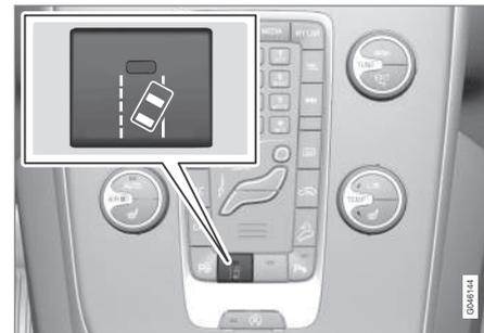
Pulse el botón de la consola central para activar o apagar la función. La luz del botón encendida indica que la función está conectada.
