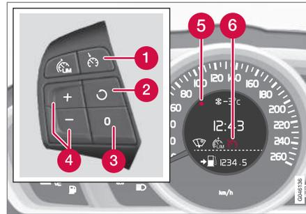
Teclado de volante y pantalla en vehículo **con** limitador de velocidad<sup>6</sup>.
