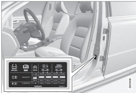
La etiqueta de presión de neumáticos situada en el montante (entre la puerta delantera y trasera) del lado del conductor especifica la presión que deben tener los neumáticos en diferentes condiciones de carga y velocidad. Esos datos se indican asimismo en la tabla de presiones de neumáticos.
