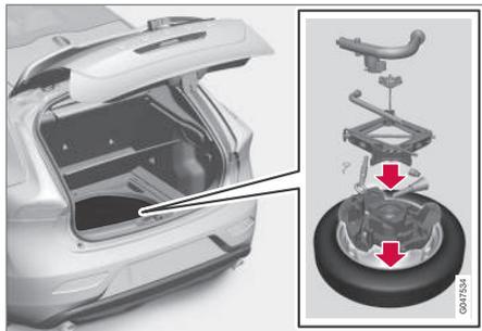
Tras utilizarse, las herramientas y el gato deben guardarse en el bloque de gomaespuma de forma correcta.
