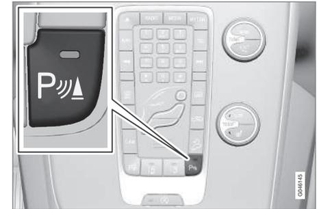
Conexión y desconexión de los sensores de aparcamiento asistido y CTA<sup>28</sup>.
