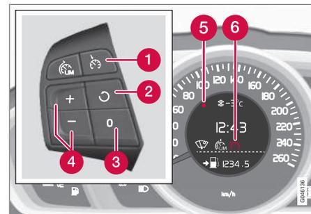
Teclado de volante y pantalla en vehículo **con** limitador de velocidad<sup>7</sup>.
