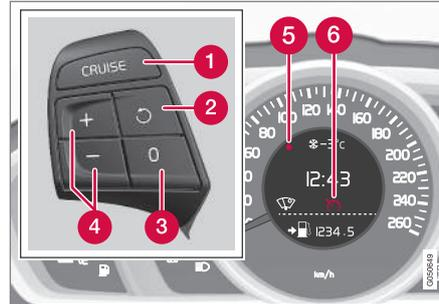
Teclado de volante y pantalla en vehículo **sin** limitador de velocidad<sup>8</sup>.
