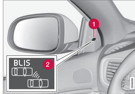
Colocación de la lámpara BLIS<sup>36</sup>.
