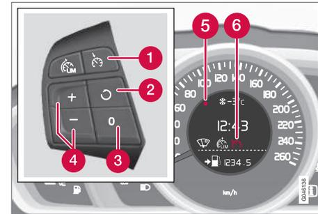
Teclado de volante y pantalla en vehículo **con** limitador de velocidad<sup>8</sup>.
