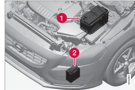
(1) Batería de arranque<sup>17</sup> (2) Batería de apoyo
