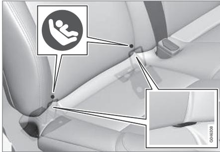
Los puntos de fijación del sistema ISOFIX están en la parte inferior del respaldo del asiento trasero, en las plazas laterales.
