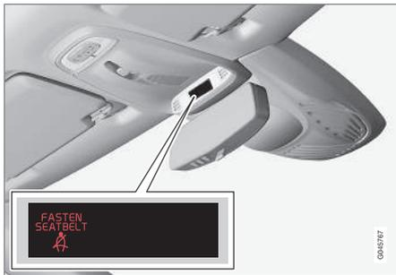
El aviso acústico depende de la velocidad y, en algunos casos, del tiempo. La señal luminosa se puede ver en la consola del techo y en el cuadro de instrumentos (p. 64).
