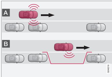
La función PAP busca y comprueba si la superficie de estacionamiento es lo suficientemente amplia. Proceda como sigue:
