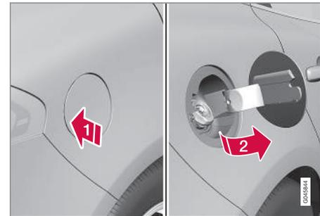
1) Abra la tapa del depósito presionando ligeramente la parte trasera de la tapa.
