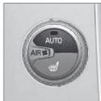
La función Auto regula de forma automática la temperatura (p. 136), el aire acondicionado (p. 137), la velocidad del ventilador (p. 135), la recirculación (p. 138) y la distribución de aire (p. 130).
