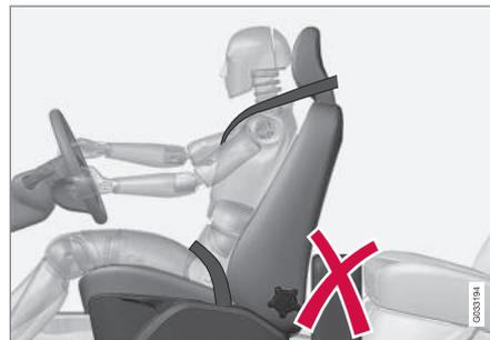
No coloque en el suelo detrás del asiento del conductor o del acompañante objetos que puedan impedir el debido funcionamiento del sistema WHIPS.
