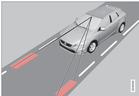
Una cámara se encarga de detectar las líneas pintadas que delimitan la vía o el carril. Si el automóvil está a punto de cruzar una línea lateral, el sistema de permanencia en el carril controlará activamente la dirección del automóvil girando el volante para volver al carril.
