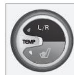
La temperatura del lado del conductor y del lado del acompañante puede ajustarse independientemente. Pulse varias veces **L/R** con el botón para seleccionar el ajuste izquierda, derecha o
