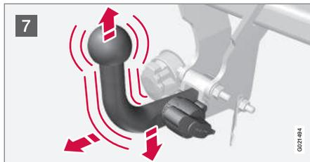
7 Compruebe que el enganche desmontable está fijo tirando hacia arriba, hacia abajo y hacia atrás.
