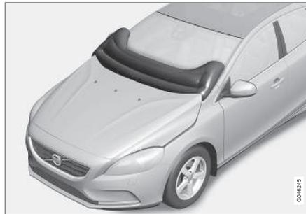
El airbag para peatones (Pedestrian Airbag) está instalado debajo del capó junto al parabrisas. En ciertas colisiones frontales con un peatón, los sensores en el parachoques delantero reaccionan y el airbag se despliega si se calcula que la fuerza del impacto es lo suficientemente grande. Los sensores están activos a velocidades de aprox. 20-50 Km/h y una temperatura ambiente entre -20 y +70 °C.
