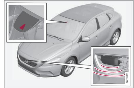
Sensor de cámara y de radar<sup>25</sup>.
