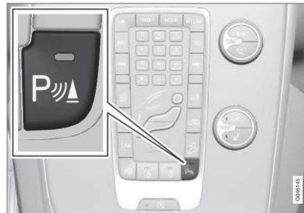
*Conexión y desconexión de los sensores de aparcamiento asistido y CTA.*
