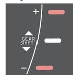
Indicador de cambio de marcha para caja de cambios manual. Sólo se ilumina al mismo tiempo un marcador - en conducción normal se enciende únicamente el situado en medio.
