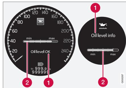
Mensaje y gráfico en la pantalla. La pantalla de la izquierda muestra el cuadro de instrumentos digital y la del lado derecho el cuadro de instrumentos analógico.
