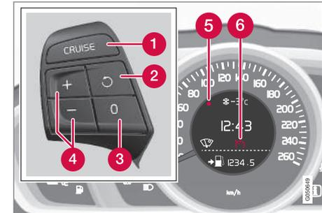
Teclado de volante y pantalla en vehículo **sin** limitador de velocidad<sup>5</sup>.
