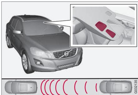
Ventanas del emisor y el receptor del sensor láser<sup>17</sup>.
