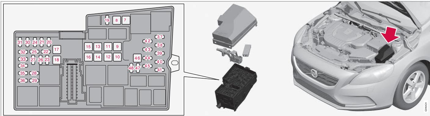
Detrás de la tapa hay unas pinzas que facilitan la extracción y la instalación de los fusibles.
