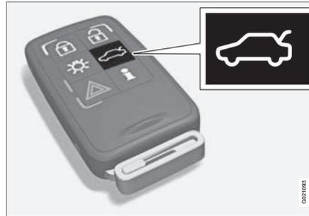
Con el botón
