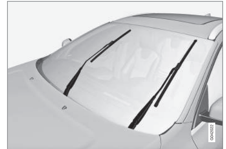
Balais d'essuie-glace en position d'entretien.
