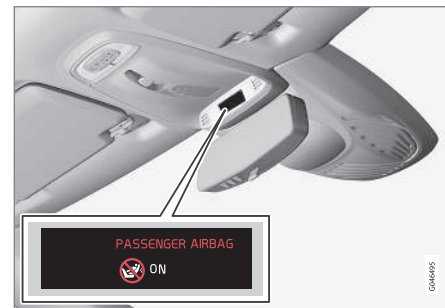
Indication de coussin gonflable pour passager avant activé.
