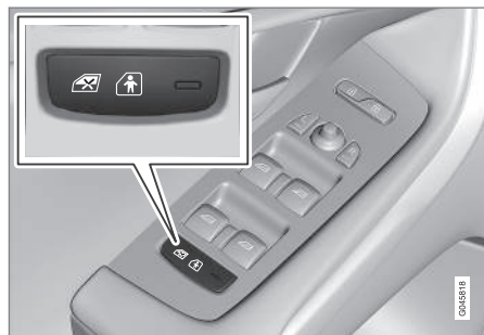
Panneau de commande porte conducteur.
