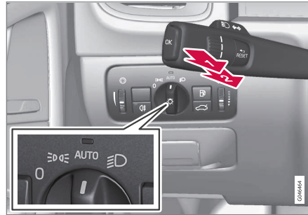
Stuurhendel en verlichtingsdraaiknop.
