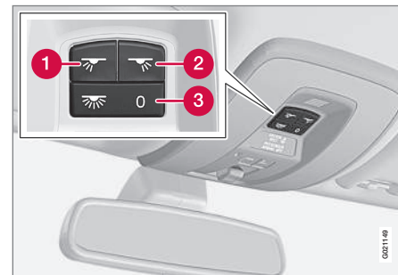
Knoppen op plafondconsole voor bediening leeslampjes en interieurverlichting voorin.
