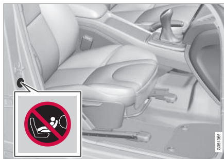
2. možnost: Umístění štítku airbagu na sloupku dveří na straně spolujezdce. Štítek airbagu uvidíte po otevření dveří spolujezdce.
