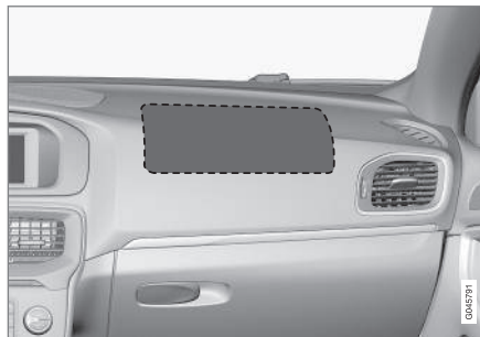
Umístění airbagu předního spolujezdce ve voze s levostranným řízením.
