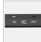
**ON:** Il sistema comanda automaticamente il climatizzatore, raffreddando e deumidificando l'aria in entrata.
