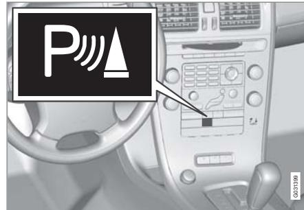
Il sistema si attiva automaticamente quando si avvia l'automobile e la spia On/Off sull'interruttore si accende. Disattivando l'assistenza al parcheggio con il pulsante, la spia si spegne.
