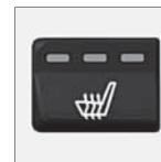
Premendo il pulsante una volta si ottiene il livello di riscaldamento max – 3 spie accese.
