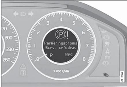
**Freno staz. non compl. disins.** - Un'anomalia impedisce il disinserimento del freno di stazionamento. Rivolgersi a un riparatore autorizzato Volvo. Se ci si mette in marcia con questo messaggio di errore viene emesso un segnale acustico.
