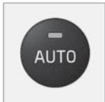
La funzione regola automaticamente temperatura, climatizzatore, velocità della ventola, ricircolo e distribuzione dell'aria.
