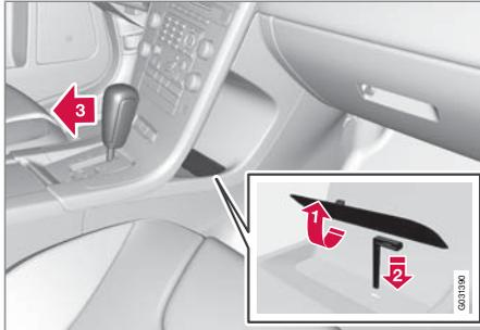
Se non è possibile guidare l'automobile, ad esempio perché la batteria di avviamento è scarica, occorre deselezionare la posizione **P** della leva selettore per spostare l'automobile.
