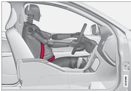
La cintura di sicurezza deve sempre essere utilizzata in gravidanza, ma è importante che sia utilizzata correttamente. La cintura di sicurezza deve essere aderente alla spalla, con la sezione diagonale tra i seni e a lato del ventre.
