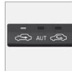
Il sistema di qualità dell'aria separa i gas e le particelle, riducendo gli odori e l'inquinamento nell'abitacolo. Se l'aria esterna è inquinata, si chiude l'entrata dell'aria e si attiva la funzione di ricircolo.
