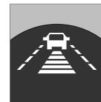
È possibile selezionare 5 distanze temporali, che vengono visualizzate sul display con 1–5 linee orizzontali – più linee sono visualizzate maggiore è la distanza temporale.
