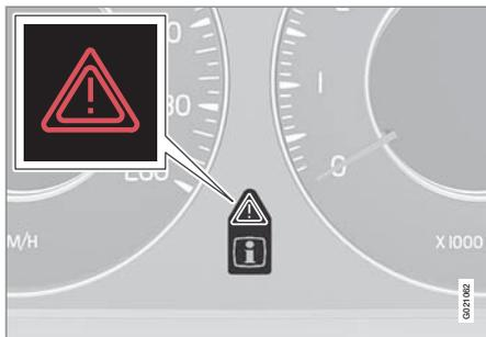
Se l'automobile è rimasta coinvolta in una collisione, potrebbe apparire il testo **Modo sicurezza Vedere manuale** sul display informativo. Questo indica che la funzionalità dell'automobile è ridotta. Il modo sicurezza indica un dispositivo di protezione che interviene se la collisione è tale da danneggiare funzioni importanti dell'automobile, ad esempio le linee di alimentazione, i sensori di uno dei sistemi di protezione oppure l'impianto frenante.
