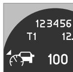
Sul lato sinistro del display viene visualizzata una spia a forma di automobile quando il sensore radar rileva un altro veicolo. La distanza dal veicolo che precede viene regolata solo quando la spia è
