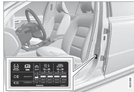
L'etichetta pressione pneumatici sul montante della portiera del conducente (tra portiera anteriore e posteriore) indica le pressioni dei pneumatici richieste in base al carico e alla velocità. Le pressioni dei pneumatici sono riportate anche nella tabella della pressione pneumatici, vedere di seguito.
