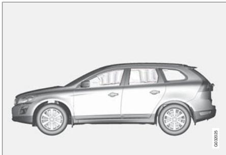
La tendina gonfiabile IC (Inflatable Curtain) è complementare agli airbag SIPS e SRS. La tendina gonfiabile è montata nel padiglione su entrambi i lati dell'automobile e protegge i passeggeri nei sedili esterni dell'automobile. In caso di collisione sufficientemente forte, i sensori reagiscono gonfiando la tendina gonfiabile. La tendina gonfiabile contribuisce a proteggere la testa del conducente e dei passeggeri dai colpi contro l'interno dell'automobile in caso di collisione.
