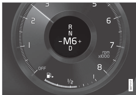
Gearskifteindikator på 12-tommers førerdisplay for lille gearstang*.
