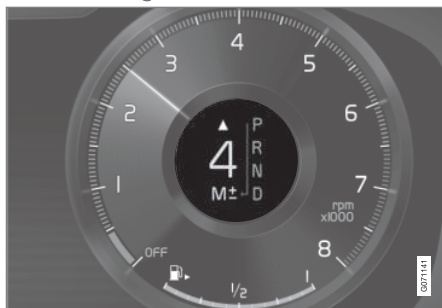
Gearskifteindikator på 12-tommers førerdisplay for stor gearstang*.
