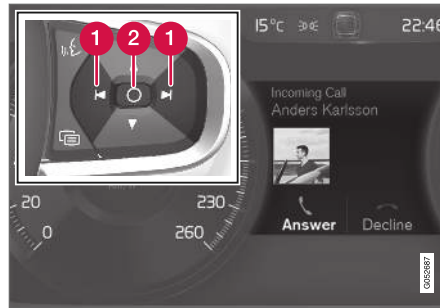
운전자 화면에 표시되는 메시지 7 의 예 및 스티어링휠의 우측 키패드
