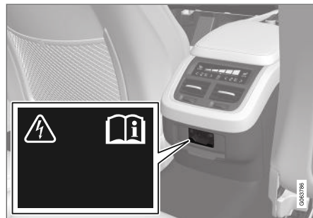
뒷좌석 터널 콘솔의 전원 소켓.
