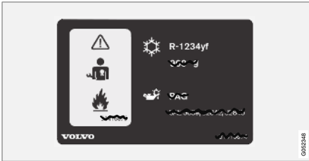
2 냉매 R1234yf를 사용하는 차량의 A/C 시스템 스티커.
