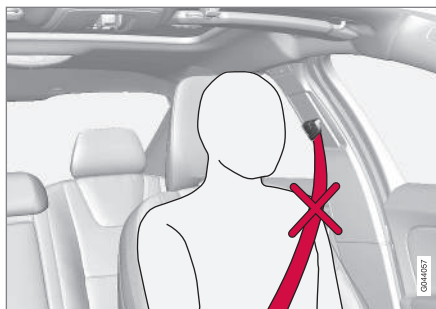
Cinto de segurança colocado incorrectamente. O cinto deve ficar sobre o ombro.
