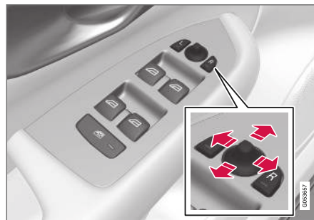
Comando dos retrovisores exteriores.
