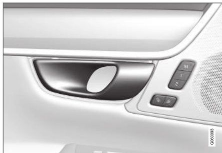
Puxador de abertura para destrancagem alternativa da porta lateral.
