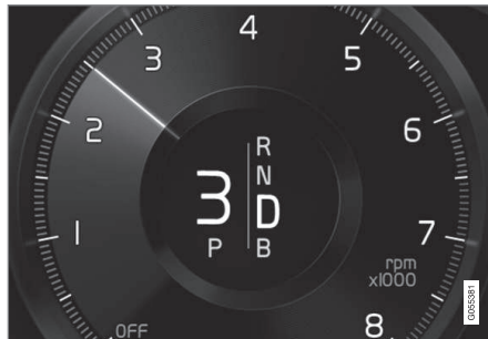
Førerdisplayet ved giring med rattspaker.
