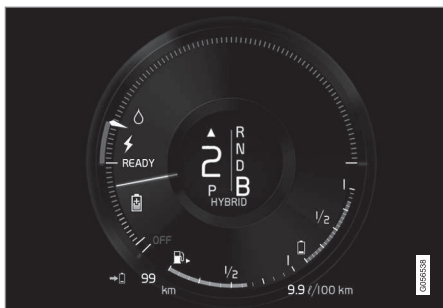
Førerdisplayet angir lading ved motorbremsing.
