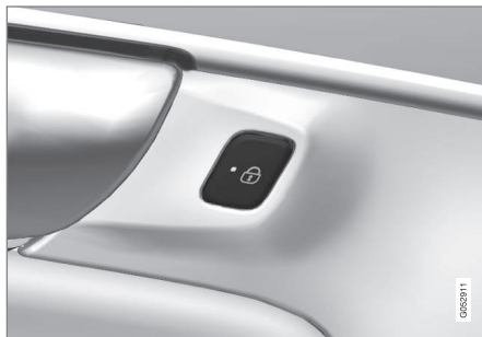
Låseknapp med indikatorlampe i bakdør.
