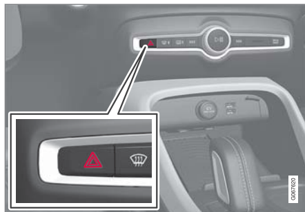
非常点滅灯ボタン
