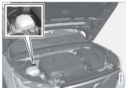
エキスパンションタンク (冷却水)
