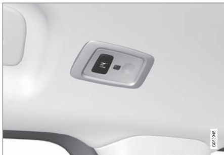
配備有全景式天窗*的車款包含兩組燈具單元，天窗兩側各一組。 7
