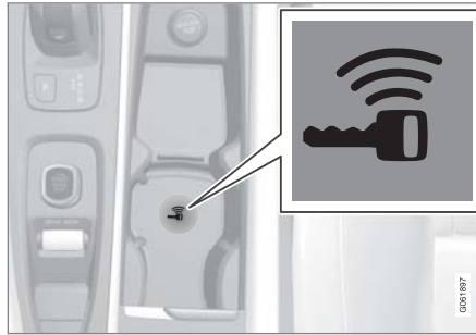
ตำแหน่งของตัวอ่านสำรองในคอนโซลบริเวณโพงเพลากลาง
