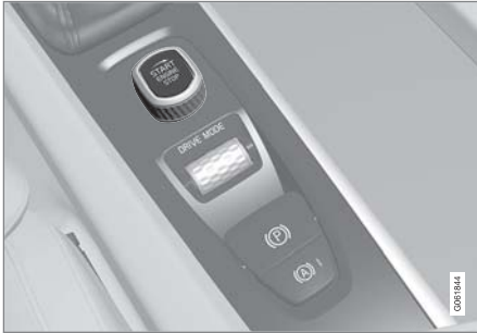
ปุ่มสตาร์ทที่คอนโซลบริเวณโพงเพลากลาง
