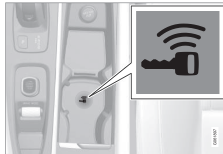
Backup-läsarens placering i tunnelkonsolen.
