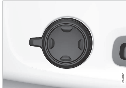
Multifunktionsreglaget, i bilar med fyrvägssvankstöd*.
