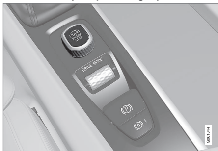
Disco de arranque na consola de túnel.
