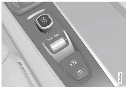
Disco de arranque na consola de túnel.
