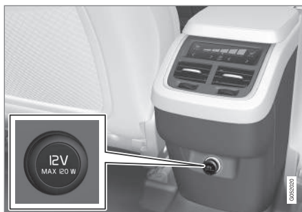
Tomada elétrica 12 V no console de túnel, segunda fileira de bancos.
