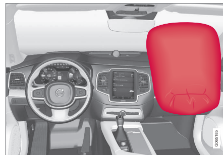
Czołowa poduszka powietrzna pasażera przedniego fotela.
