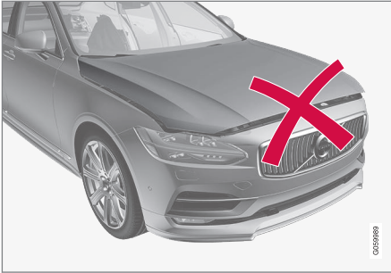
Niedomknięta pokrywa silnika.
