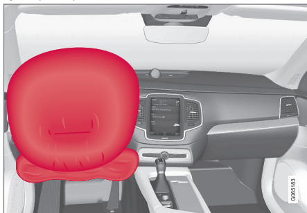
Rattkollisjonspute og knekollisjonspute på førersiden i forsetet.
