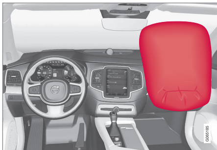
Kollisjonspute på passasjersiden i forsetet.
