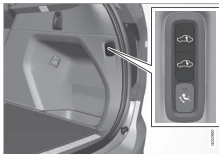
Bryter for heving/senking av bilens bakparti.
