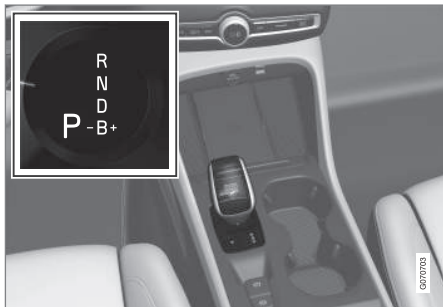
Oversikt over girspak og girskiftmønster på førerdispleyet.
