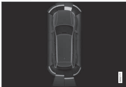
Beeldscherm met obstakelzones en sensorsegmenten.
