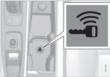
Positie back-uplezer in de tunnelconsole.
