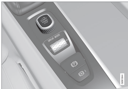
De startknop op de tunnelconsole.
