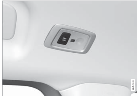
파노라마 선루프*가 장착된 차량에는 루프의 양쪽에 하나씩 두 개의 램프 유닛이 있습니다. 7
