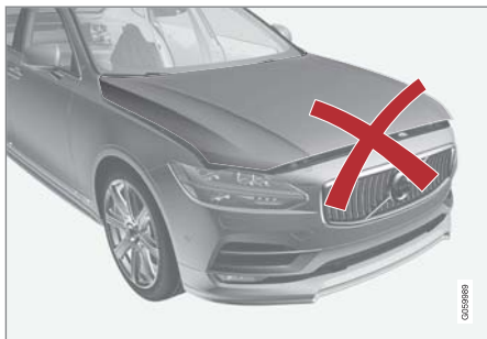
ボンネットが完全に閉じていない状態
