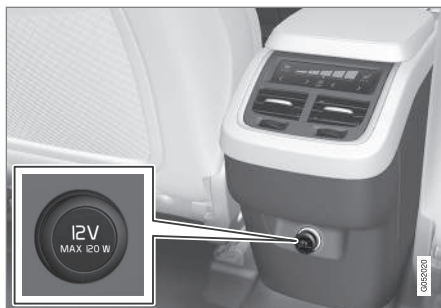
Presa elettrica da 12 V nel tunnel, seconda fila di sedili.
