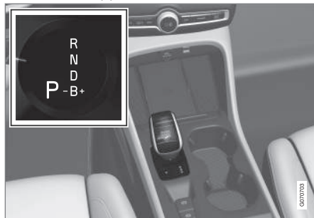
Vue d'ensemble du levier de rapport avec grille de passage des rapports à l'écran conducteur.
