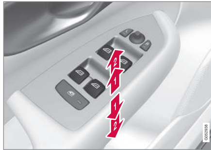
Fonctionnement des vitres électriques.
