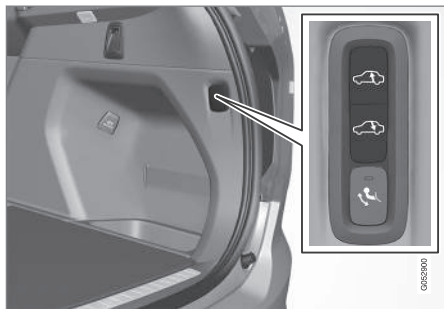
Auton takaosan nostamisen/laskemisen säädin.
