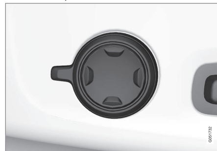
Monitoimisäädin, sijoitettu istuimen istumaosan sivulle.
