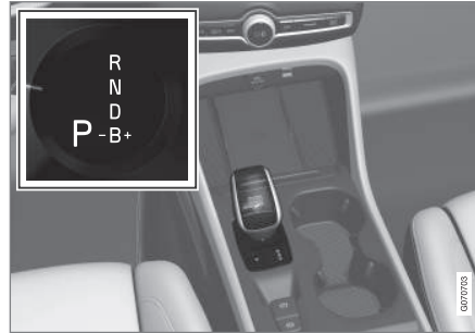
Yleiskuva vaihdevivusta ja vaihtokaaviosta kuljettajan näytössä.
