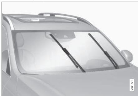
Escobillas de limpiaparabrisas en posición de servicio.
