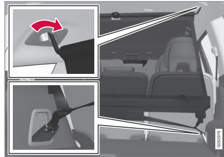
Πίσω σημείο τοποθέτησης.
