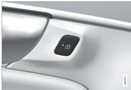
Låseknop med indikeringslampe i bagdør.
