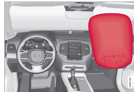
Airbag předního spolujezdce na předním sedadle.
