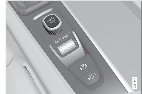
Startovací knoflík na tunelové konzole.
