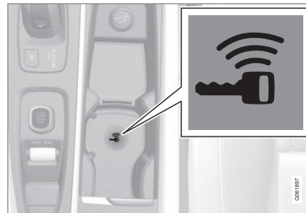
Umístění záložní čtečky v tunelové konzole.
