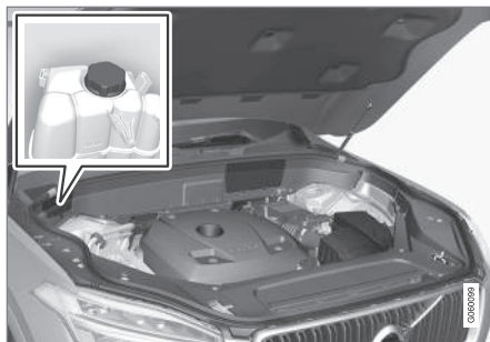
Vyrovnávací nádržka chladicí kapaliny
