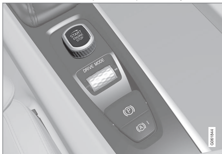
Startovací knoflík na tunelové konzole.
