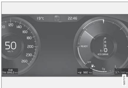
أمثلة على معلومات كمبيوتر الرحلات في شاشة السائق. الصورة تمثل رسماً توضيفياً - وقد تختلف الحقيقة عن الصورة باختلاف طراز السيارة.
