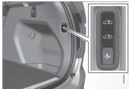
استخدم الأزرار في حجرة الحمولة لتنقّاع ارتفاع القسم الخلفي من السيارة ولتسهيل عملية التحميل والتفريج أو عند توصيل أو فصل مقطورة.
