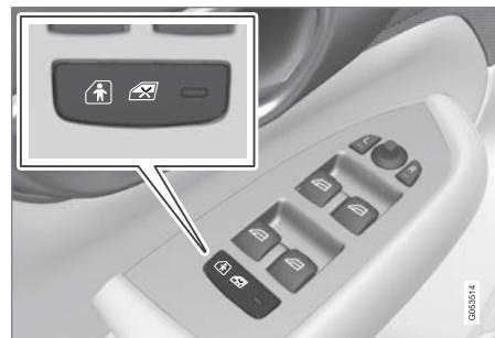
زر التنشيط وإلغاء التنشيط الكهربائي.
