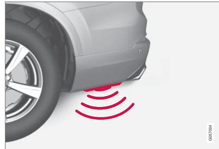
لتنشيط الفتح أو الإغلاق بحركة القدم في السيارة المزودة بلوحة انزلاق، ينبغي القيام بحركة الرجل من جانب السيارة. يجب أن يكون أحد مفاتيح التحكم عن بعد في السيارة داخل نطاق السيارة (متر واحد تقريباً (٣ أقدام)) حتى يكون الفتح والإغلاق ممكناً.
