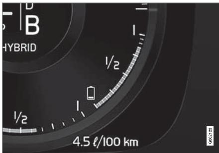
يتم استخدام الطاقة في البطارية الهجينية لتشغيل المحرك الكهربائي ولكن كذلك لتبريد السيارة أو تدفتها. يتيح حاسوب الرحلة حساب المسافة التقريرية التي يمكن قطعها بالطاقة المتبقية في البطارية الهجينية.
