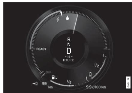
يتعدى المحرك الكهربائي توفير المقدار المطلوب من طاقة المحرك ومن ثم يبدأ عمل محرك الاحتراق الداخلي.
