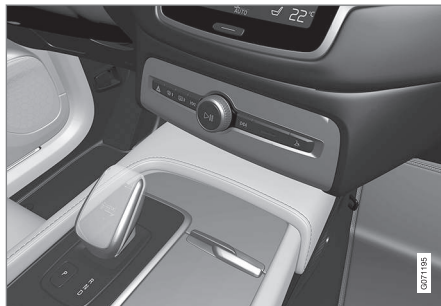
Огляд малого важеля КПП - ситуації, в яких неможливо вимкнути інгібітор селектора КПП.
