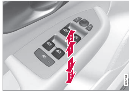
Керування вікнами з електропідійомниками.
