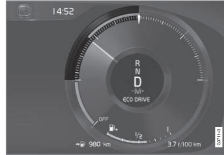
12 inç sürücü ekranındaki Eco göstergesi*.
