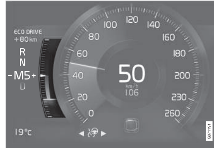
8 inç sürücü gösterge ekranındaki Eco göstergesi.
