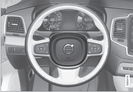
Korna, direksiyon simidinin merkezinde bulunur.
