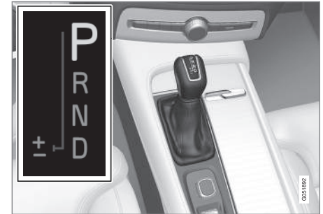
Översikt över stor växelspak och växlingsmönster i förardisplay.
