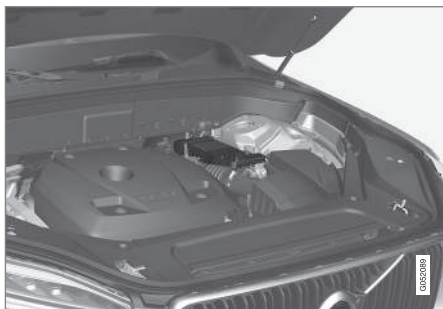
12 V stödbatteri är placerat i en box bredvid fjäderbenstornet.
