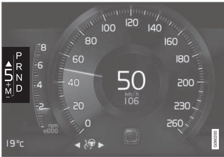
Växlingsindikator i 8-tums förardisplay för stor växelspak.
