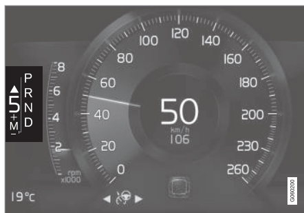
Indikátor prevodových stupňov na 8-palcovom displeji vodiča pre veľkú radiacu páku.
