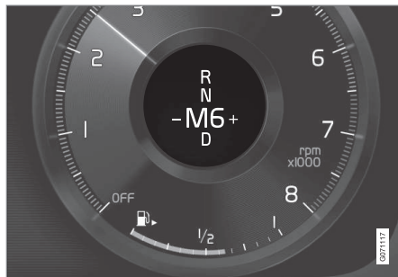
Indikátor prevodových stupňov na 12-palcovom displeji vodiča pre malú radiacu páku*.
