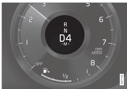
Displej vodiča pri zmene prevodového stupňa pomocou lopatiek pod volantom, malá prevodová páka.
