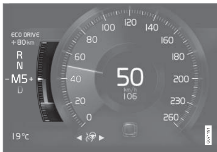
Medidor ECO no mostrador do condutor 8 polegadas.
