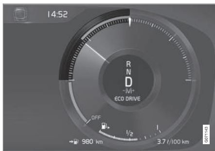
Medidor ECO no mostrador do condutor 12 polegadas*.
