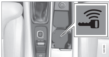
Localização do leitor no console de túnel.
