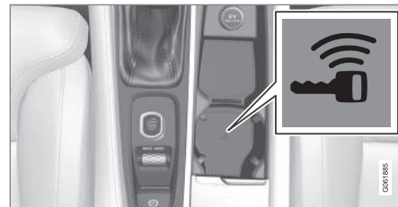
Localização do leitor no console de túnel.
