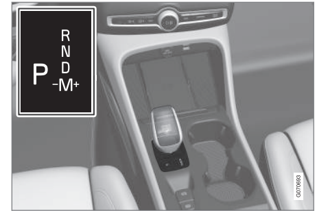
Overzicht voor de kleine schakelhendel en het schakelpatroon op bestuurdersdisplay.
