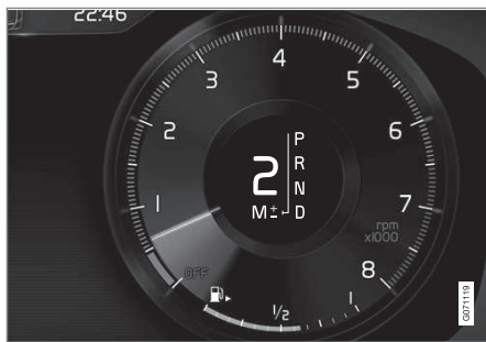
Bestuurdersdisplay bij schakelen met stuurpaddles in stand voor handmatig schakelen grote schakelhendel.
