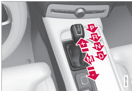
Overzicht grote schakelhendel en schakelstanden.
