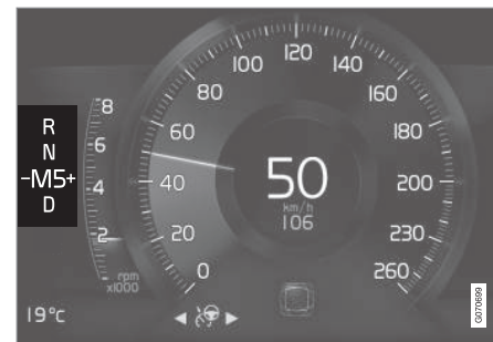
Schakelindicator op 8 inch bestuurdersdisplay voor de kleine schakelhendel.
