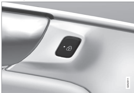
Knop voor vergrendelen in achterportier met led.
