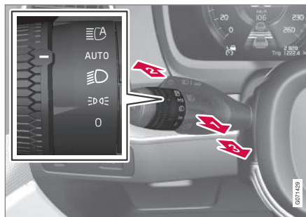
Stuurhendel met draaiing.
