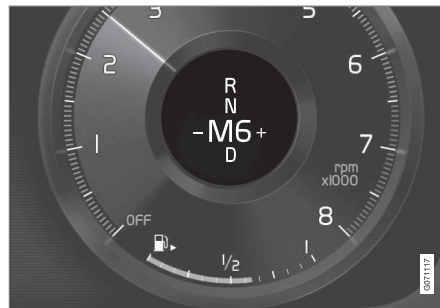
Schakelindicator op 12 inch bestuurdersdisplay voor de kleine schakelhendel*.
