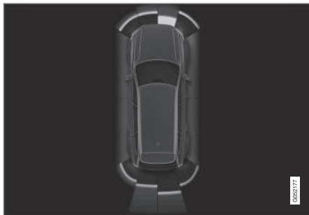
Beeldscherm met obstakelzones en sensorsegmenten.
