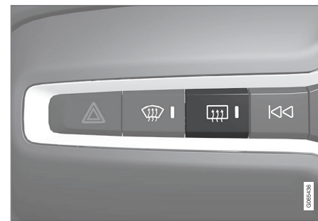
Pulsante fisico nel quadro centrale.
