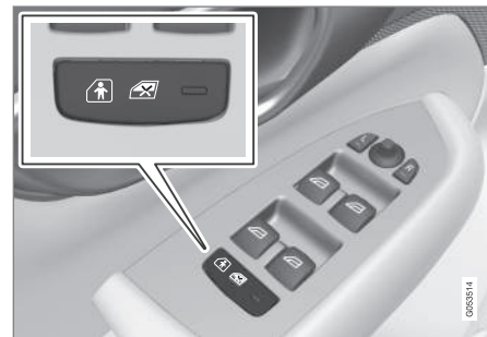
Pulsante di attivazione e disattivazione elettrica.
