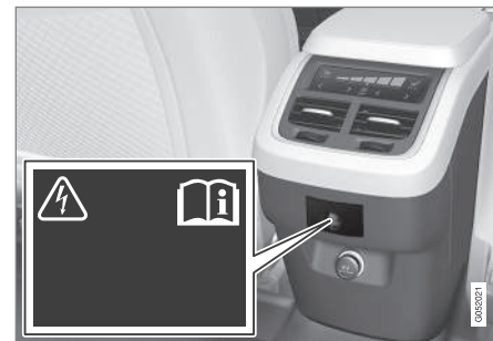
Prise électrique dans la console tunnel, deuxième rangée de sièges.
