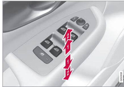
Fonctionnement des vitres électriques.
