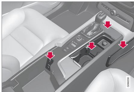
Compartimentos con portavasos, bolsillo de red\*, toma eléctrica y puerto USB en la consola del túnel.
