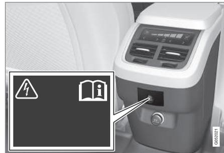
Toma eléctrica en consola del túnel, segunda fila de asientos.
