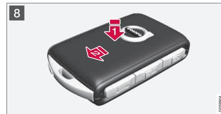
**8** **1** Dé la vuelta al mando a distancia y vuelva a colocar la carcasa de la parte delantera bajándola hasta que se oiga un clic.
