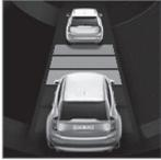
Cuando el símbolo de distancia de separación muestra dos vehículos, el control de velocidad constante adaptativo está regulando el intervalo de tiempo respecto al vehículo que circula delante.
