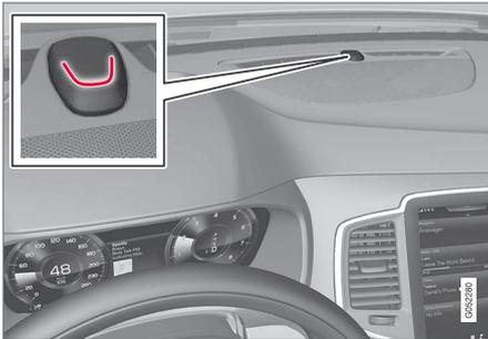
Cuando el automóvil está cerrado y la alarma activada, en el tablero de instrumentos parpadea una luz roja una vez cada dos segundos.
