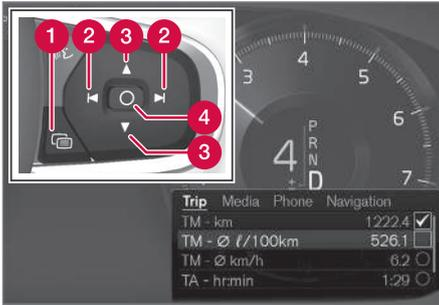
Menú de aplicaciones y teclado derecho del volante. La imagen es esquemática.
