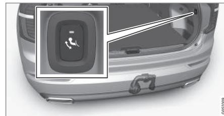
Abra el portón trasero. El botón para plegar y desplegar el enganche para remolque está situado en el lado derecho de la parte trasera del compartimento de carga. La luz de indicación del botón debe encenderse con luz fija de color naranja para que esté activa la función de despliegue.
