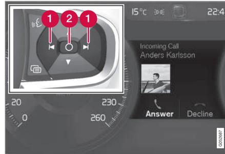
Ejemplo de mensaje en la pantalla del conductor<sup>5</sup> y teclado derecho del volante. La imagen es esquemática.
