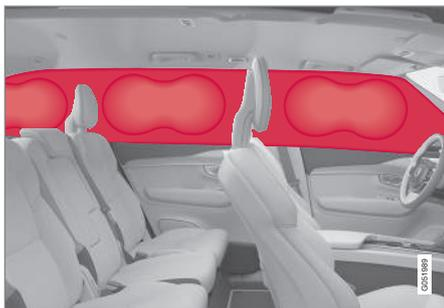
La cortina inflable va instalada sobre ambos laterales del techo interior, ayudando a proteger al conductor y a los ocupantes situados en las plazas exteriores del vehículo. Los paneles están identificados con **IC AIRBAG**.
