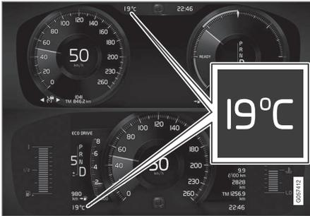
Ubicación del indicador de temperatura ambiente en las pantallas del conductor de 12" y 8". La imagen es esquemática. Los detalles pueden variar según el modelo de automóvil.
