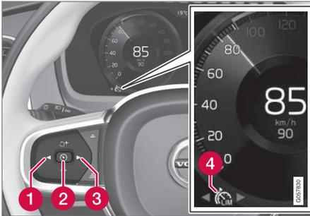
El limitador de velocidad no podrá activarse hasta el arranque del motor. La velocidad máxima más baja que puede guardarse es de 30 km/h (20 mph).
