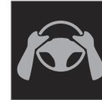
Si Pilot Assist detecta que el conductor no tiene las manos en el volante, el sistema avisa con un símbolo y un mensaje de texto en la pantalla del conductor para instar al conductor a que manibre activamente el volante del automóvil.
