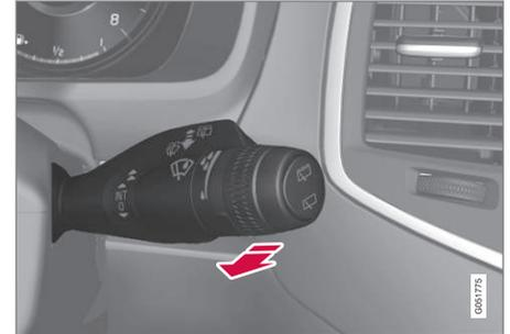
Función de lavado, palanca derecha del volante.
