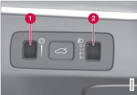
Los automóviles con faros LED<sup>2</sup>\* disponen de ajuste automático de la altura de las luces, por lo que no
