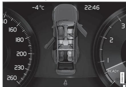
Gráfico en la pantalla del conductor con diferentes tipos de advertencias. El color de la advertencia de puertas y portón trasero depende de la velocidad del vehículo.
