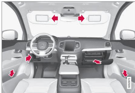
Compartimento en el panel de la puerta y junto al volante, guantera y visera.
