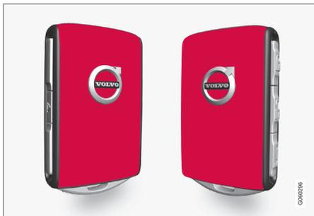
La Red Key permite definir la velocidad máxima del vehículo, programar avisos de velocidad y determinar el volumen máximo del sistema de altavoces. Además, los sistemas de ayuda del conductor del vehículo estarán siempre activos. Por lo demás, las funciones son las mismas que las de una llave normal.
