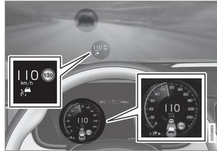
La imagen anterior muestra que se ha ajustado el control de velocidad constante adaptativo para mantener una velocidad de 110 km/h (68 mph) al tiempo que sigue a un vehículo delantero que mantiene la misma velocidad.
