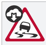
En caso de alarma por calzada resbaladiza, aparece este símbolo en la pantalla del conductor cuando un vehículo se aproxima al tramo de calzada resbaladiza, tanto en el automóvil propio como en otros vehículos que hayan recibido la información a través de Connected Safety.
