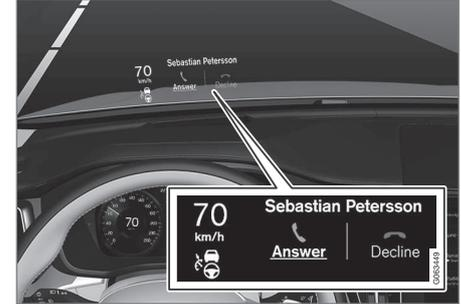
La pantalla de visualización frontal muestra advertencias e información referentes a la velocidad, las funciones del control de velocidad constante, la navegación, etc. en el campo visual del conductor. En la pantalla de visualización frontal se puede mostrar también información de señales de tráfico y llamadas telefónicas entrantes.
