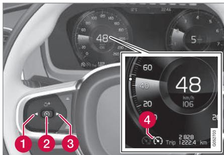
Para poder activar el control de velocidad constante desde el modo de espera, el vehículo debe circular a como mínimo 30 km/h (20 mph).
