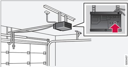
4. Busque el botón de aprendizaje<sup>34</sup> en el receptor de, por ejemplo, la puerta del garaje. Suele estar situado cerca de la sujeción de la antena en el receptor.
