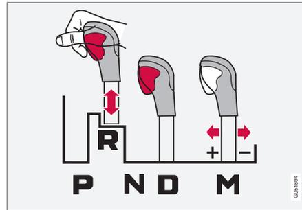
Inhibidor del selector de marchas en automóviles con palanca de cambios grande.
