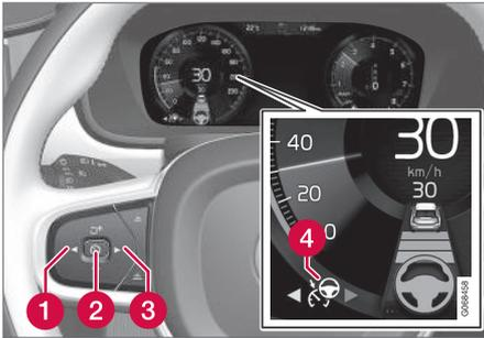
El volante VERDE indica que Pilot Assist proporciona asistencia de dirección.
