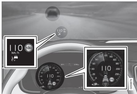
La imagen anterior muestra que se ha ajustado Pilot Assist para mantener una velocidad de 110 km/h (68 mph) al tiempo que sigue a un vehículo delantero que mantiene la misma velocidad.
