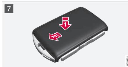
**7** **1** Vuelva a colocar la carcasa de la parte trasera y bájela hasta que se oiga un clic.
