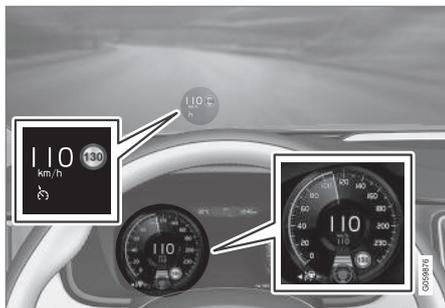
La imagen anterior muestra que se ha ajustado Pilot Assist para mantener una velocidad de 110 km/h (68 mph) y que no hay ningún vehículo delantero que seguir.
