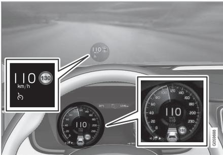
La imagen anterior muestra que se ha ajustado el control de velocidad constante adaptativo para mantener una velocidad de 110 km/h (68 mph) y que no hay ningún vehículo delante que seguir.
