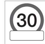
Un símbolo de señal suplementaria en forma de un marco vacío debajo del símbolo de velocidad<sup>26</sup> en la pantalla del conductor significa que la función ha identificado una señal con información suplementaria sobre la limitación de velocidad.
