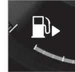
En la pantalla del conductor, la flecha junto al símbolo de repostaje indica el lado en que está situada la tapa del depósito.
