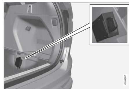
Coloque una tarjeta SIM personal en el soporte.
