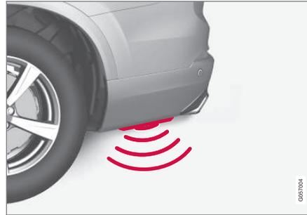
Para activar la apertura o el cierre mediante un movimiento con el pie en automóviles con placa protectora de bajos, dicho movimiento se efectúa desde un lado del vehículo. Una de las llaves del automóvil debe encontrarse dentro del alcance previsto (aproximadamente 1 metro (3 pies)) para que se pueda efectuar la apertura y el cierre.
