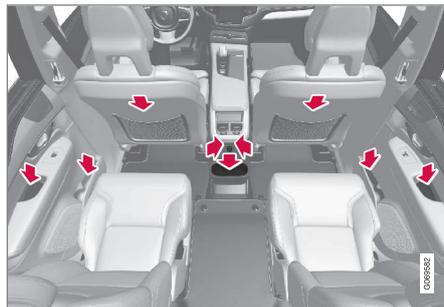
Compartimento en el panel de puerta, portavasos en el piso de la consola del túnel, bolsillo\* en el respaldo del asiento delantero y toma eléctrica en la consola del túnel.
