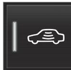
Pulse el botón **Protección reducida** en la vista de funciones de la pantalla central para desactivar los sensores de movimiento e inclinación la siguiente vez que se cierre el automóvil.
