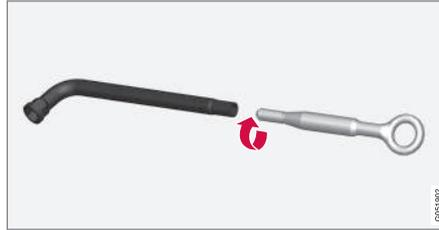
3. Desmonte los capuchones de plástico de los tornillos de rueda con la herramienta correspondiente.
