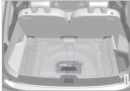
Si, en cambio, el automóvil está equipado con batería de apoyo de 48 V, está situada debajo del compartimento de carga. La caja sobre la batería de apoyo de 48 V solo puede retirarse en un taller autorizado.
