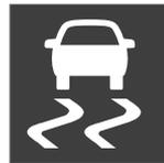
Cuando actúa el control de estabilidad del remolque, el símbolo ESC destella en la pantalla del conductor.
