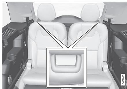
1. Tire hacia arriba y hacia adelante de la palanca situada en la parte superior del respaldo.
