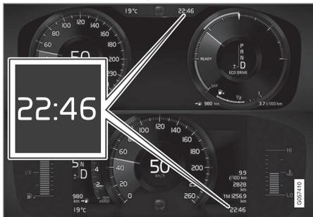
Ubicación del reloj en las pantallas del conductor de 12" y de 8". La imagen es esquemática. Los detalles pueden variar según el modelo de automóvil.
