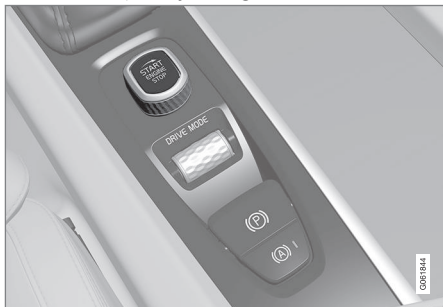
Startknappen i tunnelkonsollen.
