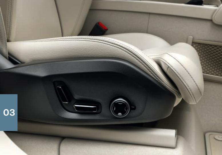
1. Durch Drehen des Schalters nach oben/unten die Sitzverstellung auf dem Center Display aktivieren.
