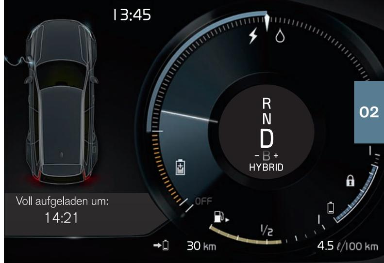
Display. Im Modus **Charge** wird die Hybridbatterie aufgeladen, wenn sie nur noch schwach geladen ist. Im Modus **Hold** wird der Ladezustand der Batterie erhalten, sodass das Fahrzeug zu einem späteren Zeitpunkt im Elektrobetrieb gefahren werden kann.
