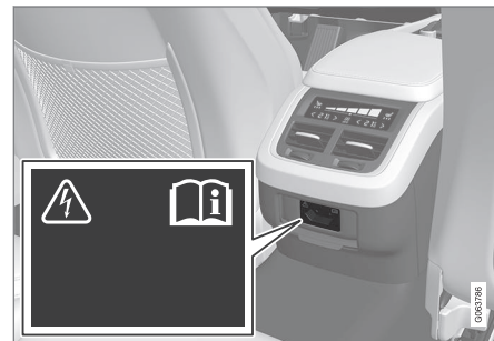
Електророзетка на тунельній консолі, заднє сидіння.
