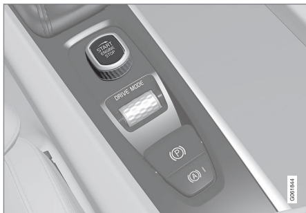
Кнопка запуску на тунельній консолі.
