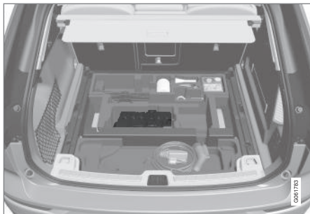
Стартерний акумулятор знаходиться в багажному відділенні.
