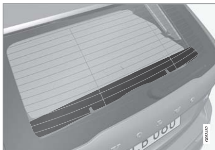
แผงปิดด้านหลังที่ติดตั้งเข้ากับด้านในของประตูท้ายจะช่วยเสริมการทำงานของแผงปิดห้องเก็บสัมภาระ
