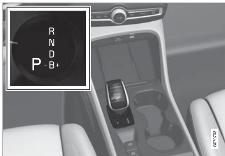
ภาพรวมของคันเกียร์และรูปแบบการเปลี่ยนเกียร์บนจอแสดงผลสำหรับคนขับ
