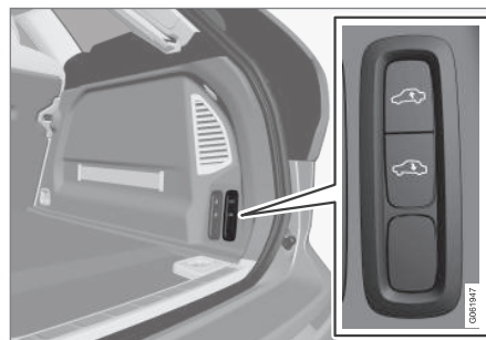
Регулятор для опускания/подъема задней части автомобиля.
