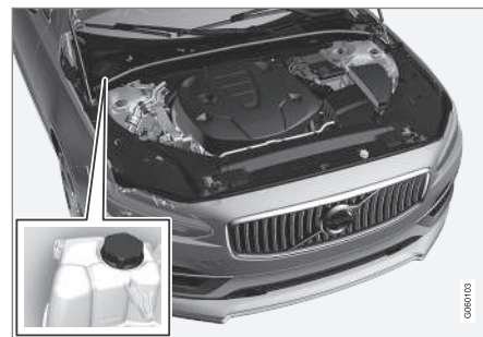
Расширительный бачок системы охлаждения, автомобиль с левосторонним управлением
