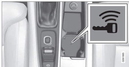
Резервное считывающее устройство в подстаканнике.
