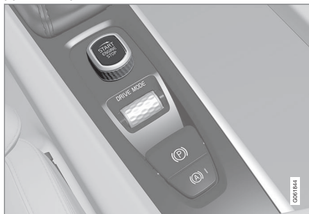
Ручка запуска в тоннельной консоли.
