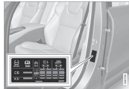
Расположение наклейки с указанием давления в шинах
