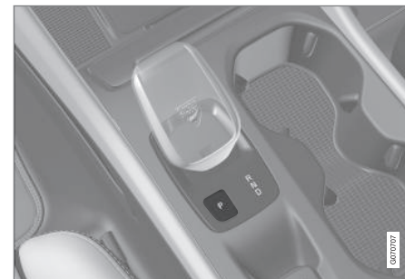
Рычаг переключения передач и положение P.
