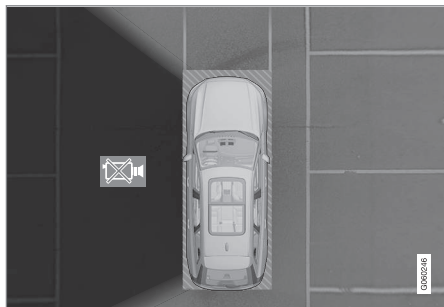
Левая камера автомобиля не работает.
