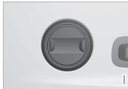
Butonul la mașinile cu suport lombar pe două direcții*.
