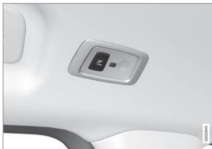
La mașinile cu plafon panoramic*, există două lămpi, câte una pe fiecare parte a plafonului.
