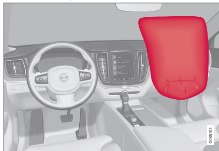
Airbagul pasagerului din față din scaunul față.
