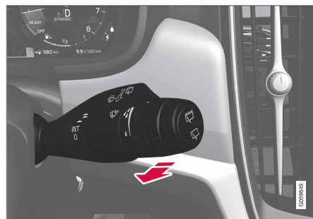
Funcția de spălare, maneta din dreapta
