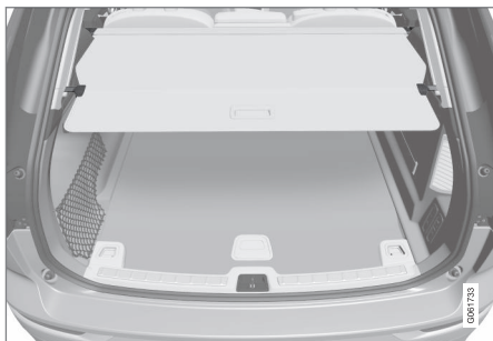
Capacul portbagajului în poziția acoperire completă.
