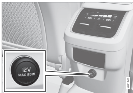
Priza electrică de 12 V din consola tunel, scaunul spate.
