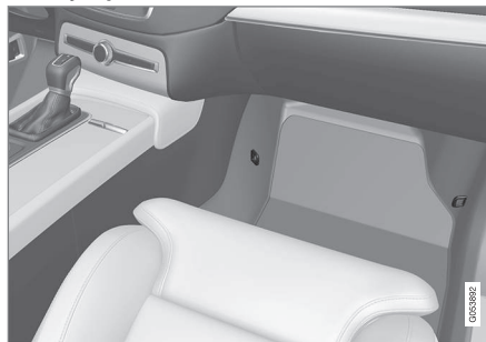
Locațiile punctelor de fixare pe scaunul față.
