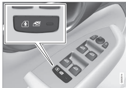
Buton pentru activarea și dezactivarea electrică.
